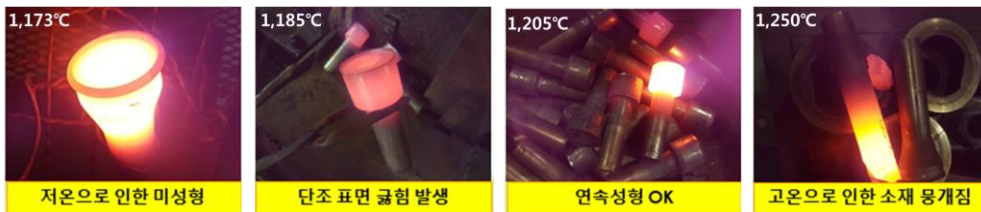
그림 2. 초기가열온도에 따른 시제품 제작 결과
